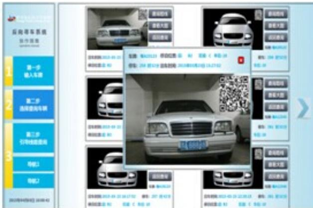
车主在确认自己的车辆以后，系统会自动生成二维码，车主可使用微信或者支付宝进行扫码，并完成支付。支付信息会自动同步到停车场，出场时自动开闸出场。
