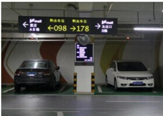
一旦确定车辆，并由系统规划出最优的寻车路线，按照指示的路线车主可以最快速的寻找到自己的爱车，车辆驶出车位后，户外及室内的信息指示屏会自动将当前位置的空车位数增加 1，完成本次反向寻车。
